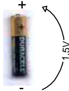
Dans un schéma électrique, les tensions se schématisent par une flèche rectiligne à côté du circuit ou du dipôle. Lorsqu'il s'agit de la tension d'un seul dipôle ou d'un groupement de dipôles, la flèche doit alors dépasser le dipôle de part et d'autre et se note  $U_x$  où l'indice  $x$  indique le dipôle concerné. Sa taille n'a aucun lien avec la valeur de la tension. Lorsqu'il s'agit de la tension entre deux points A et B d'un circuit, la flèche va du point A au point B et se note  $U_{AB}$ .
